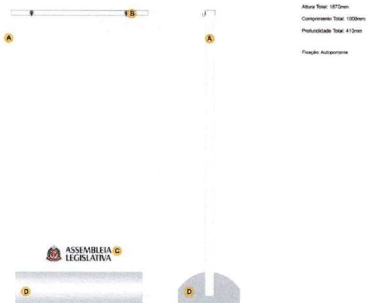
Medidas referentes ao tamanho do expositor de madeira. A base é autoportante, de alumínio
